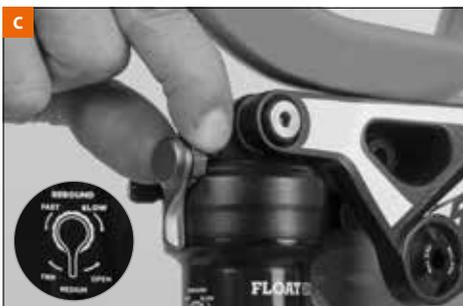
Beginnen Sie den Einstellvorgang mit ganz geöffneter Dämpfung (Zug- und Druckstufe auf „-“ bzw. „fast“). Greifen Sie den Sattel mit beiden Händen. Stützen Sie sich jetzt mit Ihrem kompletten Gewicht auf den Sattel [b] und geben Sie sofort wieder nach. Das Federbein wird mit nahezu der gleichen Geschwindigkeit wieder ausfedern, mit der Sie eingefedert haben.
