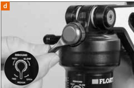
In einigen Fällen weisen Federbeine zudem eine **Druckstufendämpfung** („compression“) auf **[d+e]**. Die typische Druckstufendämpfung – oder bei manchen Federbeinen die High Speed-Druckstufendämpfung – bremst den Einfedervorgang, wenn mit hoher Geschwindigkeit über ein Hindernis gefahren wird. Eine hohe Einfedergeschwindigkeit würde das Federbein möglicherweise sonst zum Durchschlagen bringen.
