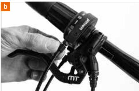
Das Drehspiel des Schaltdrehgriffes wird über die Schaltzugspannung mit den Zugeinstellern justiert. Ein Herausdrehen beider Zugeinsteller erhöht und ein Hineindreihen beider Zugeinsteller verringert die Zugspannung und damit das Drehspiel.
