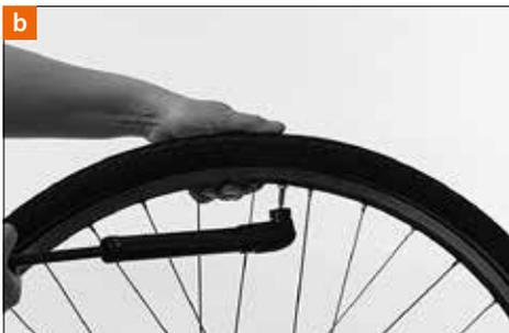
Drücken Sie das Ventil etwas ins Reifeninnere, damit der Schlauch nicht unter dem Reifen eingeklemmt wird. Prüfen Sie, ob das Ventil gerade steht. Wenn nicht, müssen Sie eine Reifenflanke demontieren und den Schlauch neu ausrichten.
