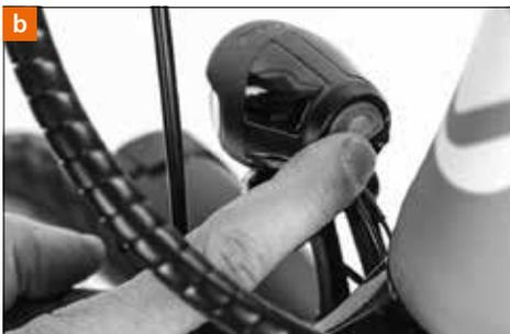
Drehen Sie die Schraube im Uhrzeigersinn schrittweise wieder an, bis der Scheinwerfer verdrehsicher in dessen Halterung ist.
