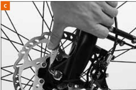
In der Endstellung muss der Hebel rechtwinklig zur Schnellspannachse liegen; er darf also keinesfalls seitlich abstehen. Der Hebel muss so am Rahmen bzw. der Gabel anliegen, dass er sich nicht unbeabsichtigt öffnet. Er sollte aber auch gut zu greifen sein, um tatsächlich schnell bedienbar zu sein.
