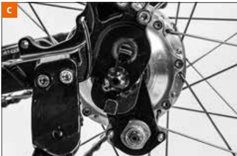
Lösen Sie anschließend den Schnellspannhebel oder die Achsmuttern. Jetzt können Sie die Kette aushängen und das Hinterrad aus dem Rahmen nehmen [c].
