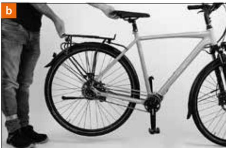
5. Heben Sie Ihr Velo de Ville-Fahrrad wenige Zentimeter an und lassen Sie es auf den Boden springen **[b]**. Entstehen dabei Geräusche, sollten Sie nach losen Schraubverbindungen suchen. Drehen Sie diese ggf. etwas an.
