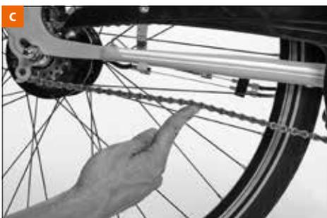
Die Zugspannung ist korrekt eingestellt, wenn die Enden der Schaltzugaußenhüllen spielfrei, aber drucklos in den Zugeinstellschrauben sitzen. Das Drehspiel am Schaltdrehgriff sollte ca. 2 mm betragen.
