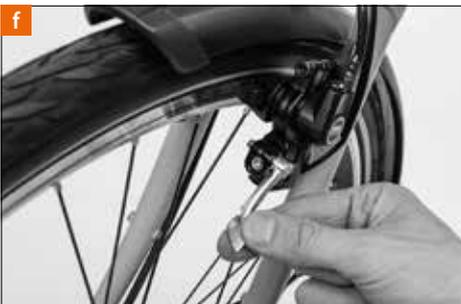
Bei **hydraulischen Felgenbremsen** der Firma Magura öffnen Sie deren Schnellspannhebel auf einer Bremsseite [f] und ziehen die Bremse vom Haltesockel.
