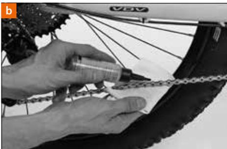
Tragen Sie auf die möglichst blanken Kettenglieder Kettenöl, -fett oder -wachs auf [b]. Drehen Sie dabei die Kurbel und beträufeln Sie die Rollen auf der Innenseite der Kette. Drehen Sie anschließend die Kette mehrere Umdrehungen durch.
