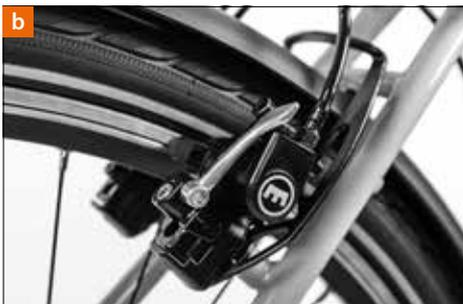
Die Seiten der Felgen sind bei Felgenbremsen auch die Bremsfläche [b]. Läuft das Laufrad nicht rund, kann das die Bremswirkung beeinflussen. Überprüfen Sie deshalb von Zeit zu Zeit den Rundlauf: Heben Sie das Laufrad hoch und versetzen Sie es von Hand in Rotation. Beobachten Sie den Spalt zwischen Felge und Bremsbelägen [c]. Verändert er sich um über einen Millimeter, sollte ein Velo de Ville-Fachhändler das Laufrad nachzentrieren.
