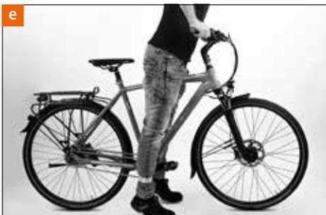
5. Lassen Sie Ihr Velo de Ville-Fahrrad aus geringer Höhe auf den Boden springen. Gehen Sie auf tretenden Klappergeräuschen nach. Prüfen Sie ggf. Lager und Schraubverbindungen.
