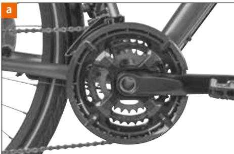
Das Tretlager [a] ist die Schnittstelle zwischen Tretkurbeln und Rahmen. Es gibt unterschiedliche Bauformen – mal gehört die Lagerwelle zum Tretlager, mal ist sie in die rechte Tretkurbel integriert. Die gedichteten Kugellager sind ab Werk wartungs- und spielfrei eingestellt. Der feste Sitz des Tretlagers im Rahmen und der Kurbeln auf der Welle muss regelmäßig überprüft werden.
