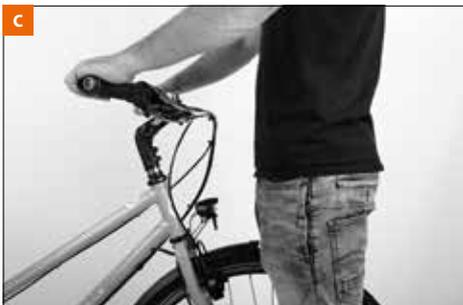
Richten Sie den Lenker so aus, dass er bei Geradeausfahrt nicht schief steht. Drehen Sie die Vorbausepindel mit einem Drehmomentschlüssel wieder fest.
