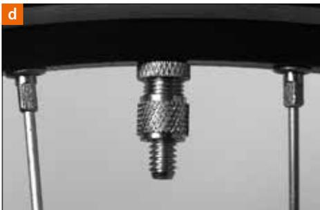
Beim Dunlopventil **[d]** müssen Sie die Rändelmutter so weit lösen, bis die Luft am Ventil vorbei ausströmt. Drehen Sie die Rändelmutter dann wieder fest. In der Regel muss der Reifen vollständig neu aufgepumpt werden.
