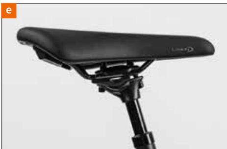
Nachdem Sie die gewünschte Position gefunden haben, überprüfen Sie, ob die beiden Hälften des Klemmechansismus am Sattelgestell anliegen, bevor Sie das Schraubendrehmoment auf den vom Sattelstützen-Hersteller angegebenen Wert erhöhen.
