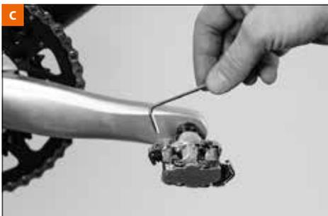
Die Auslösehärte von Systempedalen wird mit Hilfe eines Innensechskant-Schlüssels eingestellt **[c]**. Knarren oder Quietschen können Sie oft durch etwas Fett an den Kontaktpunkten beseitigen. Es könnte aber auch ein Zeichen von Verschleiß sein – genau wie kippeliger Stand. Überprüfen Sie die Platten regelmäßig.
