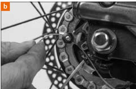
Bei **mechanischen Felgenbremsen** müssen Sie zuerst den Seilzug am Bremsarm aushängen. Fassen Sie dazu mit einer Hand um die Felge und drücken Sie die Bremsbeläge bzw. die Bremsarme zusammen. In dieser Stellung lässt sich der meist tonnenförmige Nippel des Bremsquerzuges bzw. die Zughülle (bei V-Bremsen) leicht aushängen.
