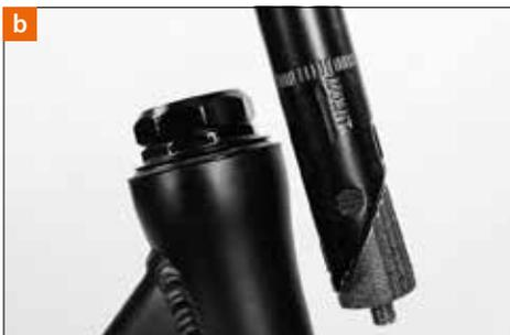
Nun können Sie die Lenker-Vorbau-Einheit auf- und abschieben. Ziehen Sie den Vorbau nicht über die Markierung (Ende, Minimum, Maximum, Stopp, Limit o.ä.) am Schaft hinaus [b]. Eine größere Einstecktiefe bedeutet in jedem Fall eine höhere Sicherheit!
