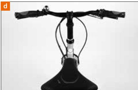
Stimmt die Beinstreckung bei einer erneuten Überprüfung? Machen Sie die Kontrolle, indem Sie den Fuß samt Pedal in die tiefste Position bringen. Wenn der Fußballen in der Mitte des Pedals steht (ideale Tretposition), muss das Knie leicht angewinkelt sein. Ist dies der Fall, haben Sie die Sattelhöhe korrekt eingestellt.
