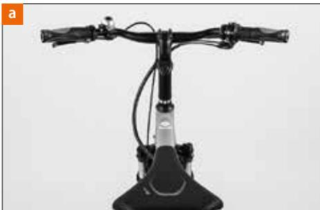
4. Peilen Sie über die Sattelspitze entlang des Oberrohres **[a]** oder zum Tretlagergehäuse, um sicherzustellen, dass der Sattel nicht verdreht ist. Öffnen Sie ggf. die Klemmung, richten Sie den Sattel aus und klemmen Sie erneut. Weitere Informationen finden Sie in den Kapiteln „Anpassen des Velo de Ville-Fahrrades an den Fahrer“, „Handhabung von Schnellspannern und Steckachsen“ und in den beigelegten Anleitungen der Komponentenhersteller.
