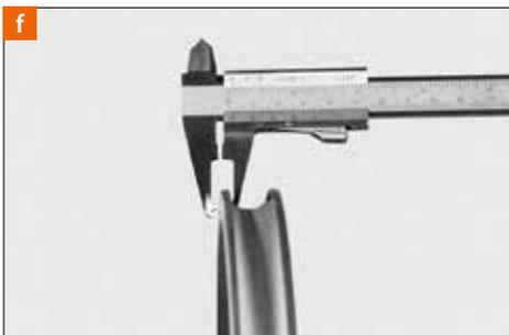
Spätestens, wenn Sie den zweiten Satz Bremsbeläge herunter gebremst haben, sollten Sie Ihren Velo de Ville-Fachhändler aufsuchen und die Felge kontrollieren lassen. Er kann die Wandstärke mittels Spezialmessgeräten überprüfen [f].
