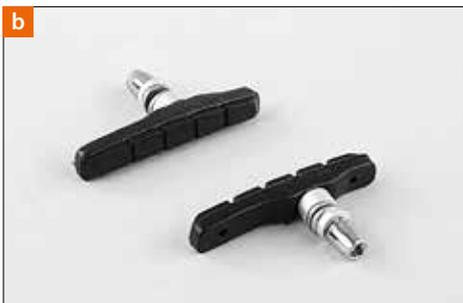
Durch die Reibung verschleifen Bremsbeläge [b] und Felgen, und zwar umso schneller, je öfter Sie in bergigem Gelände und durch Regen oder Schmutz fahren. Manche Felgen sind mit sogenannten Verschleißindikatoren versehen (z.B. Rillen oder Punkte). Wenn diese nicht mehr zu erkennen sind, müssen Sie die Felge austauschen. Unterschreitet die Felgenflanke ein kritisches Maß, kann der Reifendruck die Felge zum Bersten bringen. Das Laufrad kann blockieren oder der Schlauch kann platzen. Sturzgefahr!
