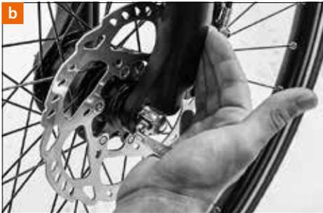
Bewegen Sie den Hebel in Richtung der Klemmposition, so dass darauf von außen „Close“ zu lesen ist. Zu Beginn der Schließbewegung bis zur Hälfte des Weges muss sich der Hebel sehr leicht bewegen lassen.
