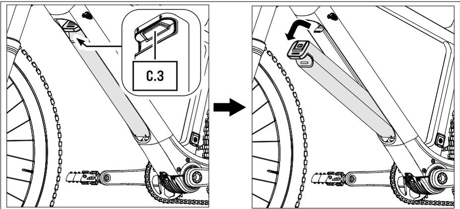
3. Halten Sie den Druckknopf gedrückt und schwenken Sie den Akku nach vorne aus der Akkuaufnahme heraus.
