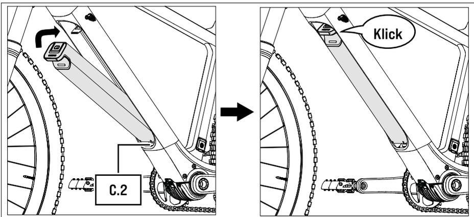
3. Schwenken Sie das obere Ende des Akkus in das Unterrohr des Pedelecs.
