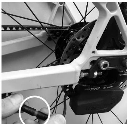
Steckverbindung der Rohloff E-14 Schalteinheit verbinden.
