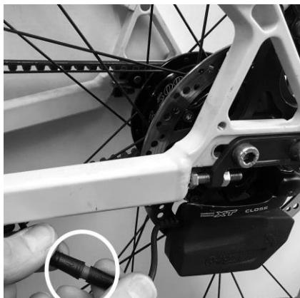
Stekkerverbinding van de Rohloff E-14 Schakeleenheid verbinden.
