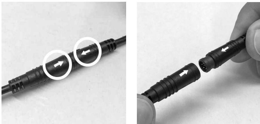
Beide Teile der Steckverbindung (Stecker/Buchse) sind außen mit einem Pfeil gekennzeichnet. Halten Sie Stecker und Buchse gerade voreinander, so dass sich die beiden Pfeile gegenüberstehen.
