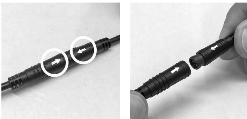
Allebei de delen van de stekkerverbinding (stekker/bus) zijn van buiten voorzien van een pijl.
