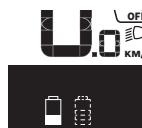
Worden bij een eBike met twee geplaatste eBike-accu's beide eBike-accu's op de fiets geladen, dan wordt op het display de laadvoortgang van de beide eBike-accu's weergegeven (op de afbeelding wordt net de linker eBike-accu geladen). Welke van de beide eBike-accu's net geladen wordt, kunt u ook zien aan de knipperende aanduiding op de eBike-accu.
