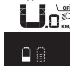
Se numa eBike com duas baterias eBike colocadas forem carregadas ambas as baterias eBike na bicicleta, então no mostrador é exibido o progresso de carregamento de ambas as baterias eBike (na imagem está a ser carregada de momento a bateria eBike esquerda). Qual das baterias eBike está a ser carregada também é reconhecível na indicação a piscar na bateria eBike.
