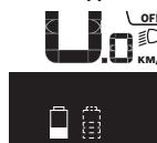
Hvis begge eBike-batteriene på en eBike med to eBike-batterier, lades på sykkelen, vises ladefremdriften til begge eBike-batteriene på displayet (på bildet lades det venstre eBike-batteriet). Du kan også se av den blinkende visningen på eBike-batteriet hvilket av de eBike-batteriene som lades for øyeblikket.
