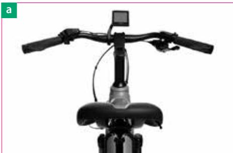
6. Peilen Sie über die Sattelspitze entlang des Oberrohres [a] oder zum Tretlagergehäuse, um sicherzustellen, dass der Sattel nicht verdreht ist. Öffnen Sie ggf. die Klemmung, richten Sie den Sattel aus und klemmen Sie erneut [b].
