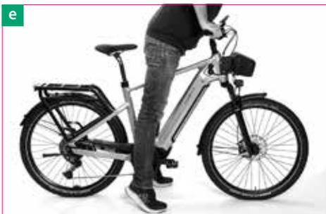
9. Lassen Sie Ihr VELO DE VILLE-Pedelec aus geringer Höhe auf den Boden springen. Gehen Sie auftretenden Klappergeräuschen nach. Prüfen Sie ggf. Lager, Schraubverbindungen und den korrekten Sitz des Akkus.
