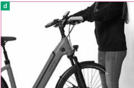
4. Überprüfen Sie, ob Lenker und Vorbau nicht verbogen oder angebrochen sind, und ob diese noch gerade stehen. Prüfen Sie, ob der Vorbau fest auf der Gabel sitzt, indem Sie versuchen, den Lenker gegenüber dem Vorderrad zu verdrehen [d]. Stützen Sie sich auch kurz auf die Bremsgriffe bzw. Brems-/Schalthebel, um den sicheren Halt des Lenkers im Vorbau zu überprüfen.
