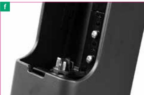
Wenn Sie den Akku Ihres VELO DE VILLE-Pedelecs vom Unterrohr oder Gepäckträger entnommen haben: Achten Sie darauf, dass weder Schmutz noch Nässe an die Anschlüsse des Akkus [f] gelangen. Stecken Sie die evtl. mitgelieferte Schutzabdeckung auf die Anschlüsse Ihres Akkus. Das Display und insbesondere die Beleuchtung stehen Ihnen dann allerdings nicht mehr zur Verfügung. Sie sollten Ihr VELO DE VILLE-Pedelec nicht mehr im öffentlichen Straßenverkehr benutzen.
