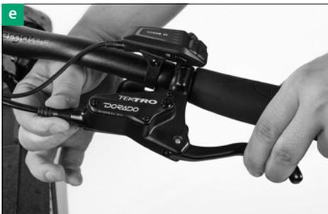
6. Sind Sie mit der Bremsanlage vertraut **[e]**? Lesen Sie im Fahrradpass nach und prüfen Sie, ob Sie die Vorderradbremse mit demselben Bremsgriff (rechts oder links) bedienen können, wie Sie es gewohnt sind. Ist dies nicht der Fall, lassen Sie die Bremsgriffe noch vor der ersten Fahrt von Ihrem VELO DE VILLE-Fachhändler umbauen. Achten Sie darauf, dass die Zuordnung der Bremshebel zur Bremse an allen Ihren Fahrrädern gleich ist.
