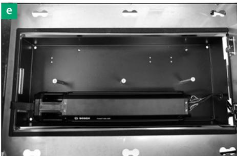
2. Überprüfen Sie den Akku bzw. die Akkus. Sollte ein Akku nicht mehr korrekt in seiner Halterung sitzen [e] oder Beschädigungen aufweisen, dürfen Sie Ihr VELO DE VILLE FR8 zumindest im Motorbetrieb nicht mehr benutzen. Schalten Sie den Antrieb und ggf. den Akku separat ab. Ein beschädigter Akku kann dazu führen, dass es zu Kurzschlüssen kommt oder Ihr VELO DE VILLE FR8 plötzlich nicht mehr unterstützt wird, wenn Sie es gerade brauchen.
