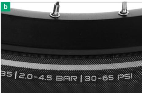
7. Sind die Reifen in gutem Zustand und haben beide Reifen genügend Druck? Ein höherer Druck ergibt eine bessere Fahrstabilität und erhöht die Pannensicherheit. Die Angaben über Mindest- und Maximaldruck (in bar oder psi) finden Sie seitlich auf der Reifenflanke **[b]**.
