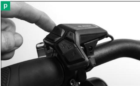
**[n]** LEDs am Bedienelement zeigen die Ladetätigkeit, den Ladezustand des Akkus und eventuelle Fehlermeldungen an. Die benötigte Ladedauer ist abhängig von der Restladung des Akkus und der Umgebungstemperatur.
